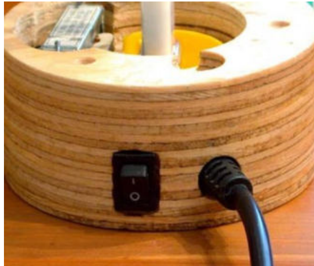
ใส่สวิตช์ไฟ กับสายไฟตามช่องที่เจาะไว้
