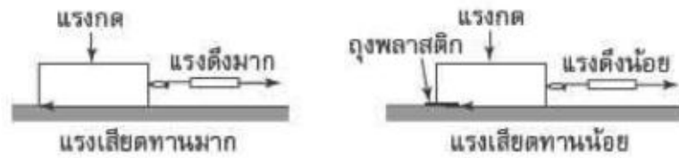
รูป ก แรงเสียดทานมาก รูป ข แรงเสียดทานน้อย
