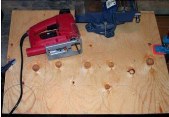
ตัดแผ่นไม้อัดหนาขนาด 3/8 นิ้ว เป็นรูปวงกลมขนาด แผ่นซีดี จำนวน 18 แผ่น
