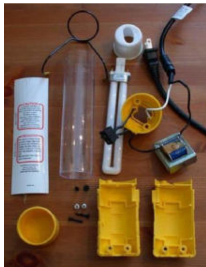
ถอดส่วนประกอบหลอดไฟออก เพื่อจะได้แยกเอาสวิทช์กับหลอดไฟ ไว้สำหรับติดนอกกล่องโคมไฟ
