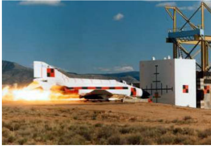
ภาพการทดสอบโครงสร้างคลุมปีกเครื่องบินโดยการชนของเครื่องบิน
