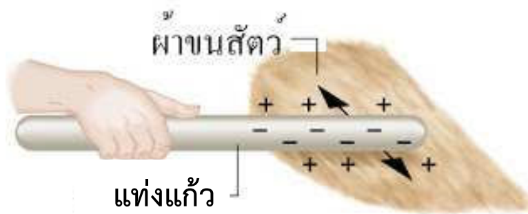
ภาพอุปกรณ์ไฟฟ้าที่เกิดจากการเสียดสีของวัตถุ
