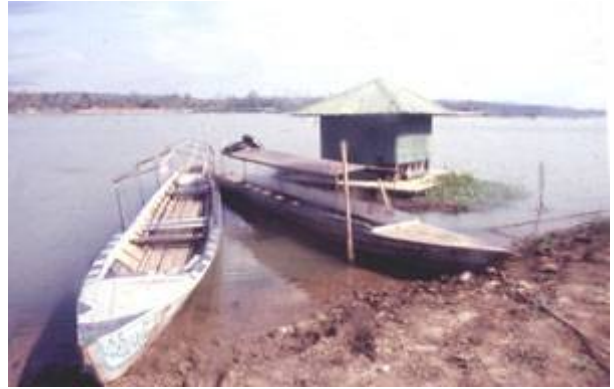
ภาพที่ 12 คล้ายกับภาพที่ 11 โดยมีป้อมลอยน้ำมาเสริมน้ำหนักให้เรือลำที่อยู่ด้านหลังมีความสมดุลกับเรือลำแรก
